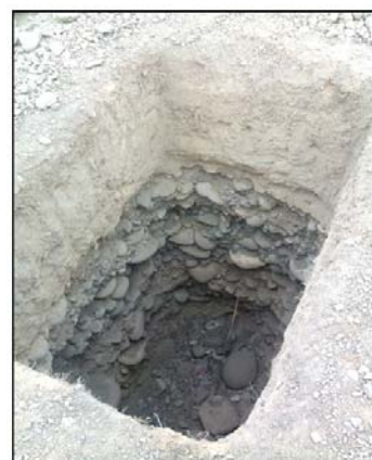
Fig. N°7: Calicata, perfil de subsuelo de las áreas agrícolas de la margen izquierda.
